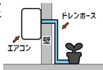
それから、夏は、室内機が冷たくなるので、ドレンホースをつたって、水が外に出ます。でも、冬、暖房運転時は、室内機の空気が暖められると、外の機械は、冷たくなります。冷たくなる室外機は、露が浮き、室外機の下部からそのまま水が流れます。よく、ドレンホースから水が出ていませんと云われます。それで、正解です。室外機が、凍るほど寒いとその氷を溶かす水も下に排出されます。
